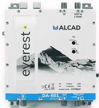
Amplificador de distribución de banda ancha para TV terrestre (117 dBuV). Dispone de regulador de ganancia y ecualizador variable. Amplifica la vía de retorno desde 5 hasta 30 MHz. Se alimenta con la fuente FF-200, una fuente de alimentación externa incluida con el amplificador. El test de entrada y el de salida permiten revisar y ajustar la instalación sin necesidad de desconectar la señal de TV.
