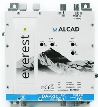
Amplificador de distribución de banda ancha para TV terrestre (117 dBuV) y satélite (118,5 dBuV). Dispone de reguladores de ganancia y equalizadores variables independientes para la parte terrestre y la de satélite. Amplifica la vía de retorno desde 5 hasta 30 MHz. Se alimenta con la fuente FF-200, una fuente de alimentación externa incluida con el amplificador. El test de entrada y el de salida permiten revisar y ajustar la instalación sin necesidad de desconectar la señal de TV.
