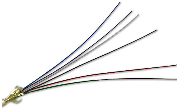
Cable para interior de 48 fibras ópticas monomodo de tipo G.657A2. Cubierta LSZH. 6 micromódulos de 8 fibras cada uno. Protección contra fuegos Dca-s1a,d1,a1. Refuerzo mediante hilado de aramida resistente a la tracción. Totalmente dieléctrico.
