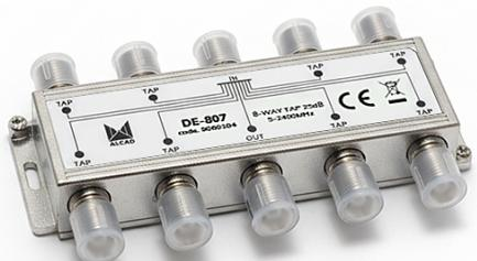
Derivadores para TV terrestre y satélite con ocho salidas derivadas, que cubren las frecuencias de 5 a 2.300 MHz. Derivan parte de la señal de entrada a sus salidas derivadas, continuando la mayor parte de la señal hacia la salida. La respuesta de las salidas derivadas es plana, sin ecualización. Disponibles en diferentes valores de atenuación de derivación.
