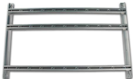
Cadre de support pour les têtes de réseau de la série 912. Il peut contenir jusqu'à une alimentation, un amplificateur et 8 modules, ou une alimentation et 9 modules. Il y a une distance de 47 mm entre les modules pour permettre une meilleure dissipation de la chaleur.
