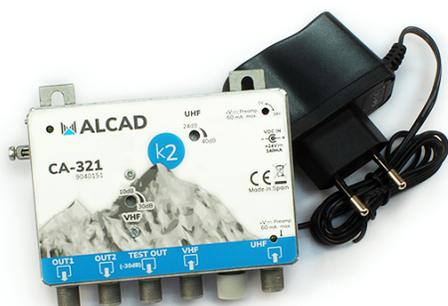
Amplificateurs à bande large pour tête de réseau avec deux entrées et deux sorties. Il y a une UHF entrée et une autre entrée pour BI/FM/BIII/DAB. Les deux sorties ont le même niveau de sortie, avec un maximum de 110 dB $\mu$ V, et facilitent la création de distributions en forme d'étoile grâce à l'utilisation de répartiteurs.
