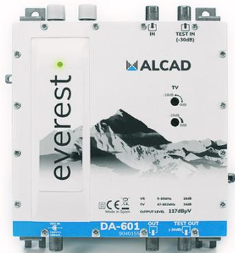
Amplificateur de distribution à large bande pour la télévision terrestre (117 dBuV). Il a un contrôle de gain et un contrôle de pente variable. Il amplifie le chemin de retour de 5 à 30 MHz. Alimenté par une alimentation externe FF-200 (incluse avec l'amplificateur). Les points de test d'entrée et de sortie permettent la vérification et le réglage de l'installation sans déconnecter le signal TV.
