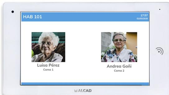
Terminal de chambre avec écran tactile de 10" du système ACCURO qui permet l'enregistrement des motifs des appels et des actions menées par les soignants. Activation par badge ou bracelet RFID pour utilisation exclusive par le personnel autorisé. Intégration sur le module ACCUROaccess pour la traçabilité et le suivi des professionnels.
