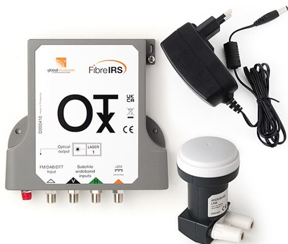
Kit optique composé de : LNB Wholeband, capable de recevoir et de transmettre tout le satellite via 2 câbles coaxiaux (V et H), émetteur optique 1310nm, avec entrées SAT (V et H) et terrestre et sortie optique FC/UPC, et alimentation externe pour alimenter l'émetteur optique et la LNB.
