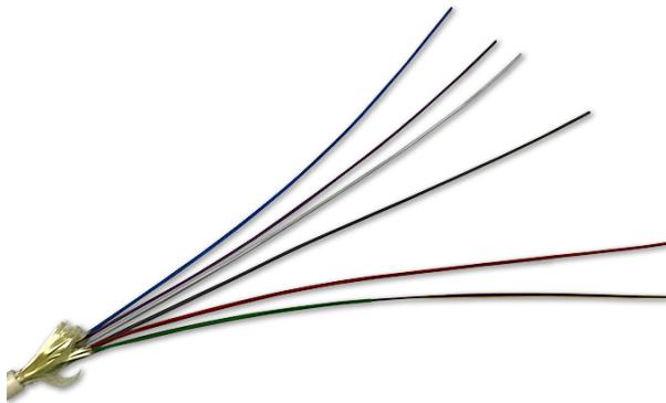
Câble de 48 fibres optiques monomodes pour usage intérieur, type G.657A2. Couverture LSZH. 6 micromodules de 8 fibres chacun. Réaction au feu Dca-s1a,d1,a1. Protection contre la traction grâce à son fil d'aramide. Entièrement dielectrique.
