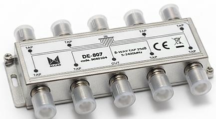
Déivateurs pour télévision terrestre et satellite, dotés de huit sorties, couvrant les fréquences de 5 MHz à 2300 MHz. Ils distribuent une partie du signal d'entrée à leurs sorties de prise tandis que la partie principale du signal continue à la sortie. La réponse des sorties de prise est plate, sans égalisation. Disponible dans différentes valeurs d'atténuation de dérivation.
