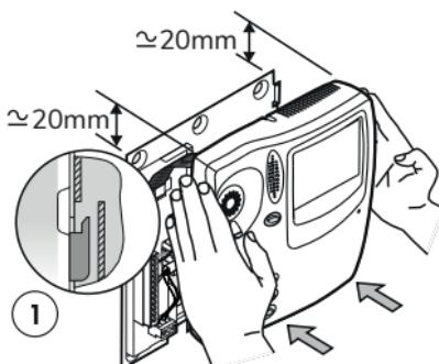
Partant de la position indiquée sur la figure (partie supérieure du moniteur située à une hauteur de 20 mm par rapport au support de connexions), approchez le moniteur vers le support de connexions, de manière à ce que les languettes supérieures de fixation du support s'emboîtent dans les glissières du socle du moniteur (1).
