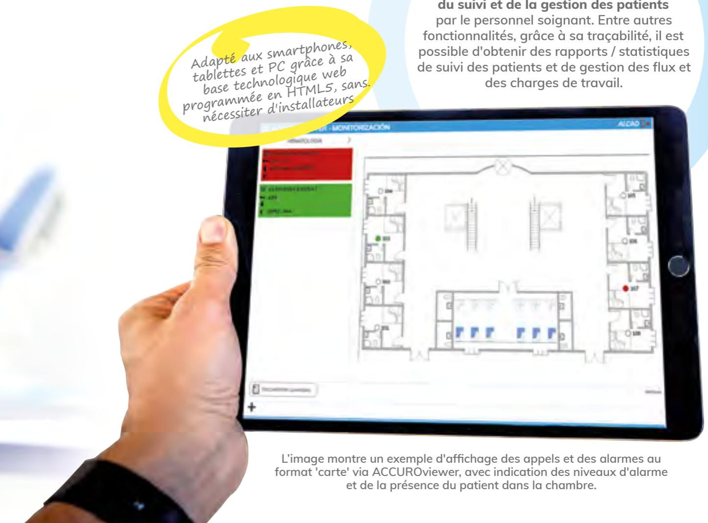
L'image montre un exemple d'affichage des appels et des alarmes au format 'carte' via ACCUROviewer, avec indication des niveaux d'alarme et de la présence du patient dans la chambre.
